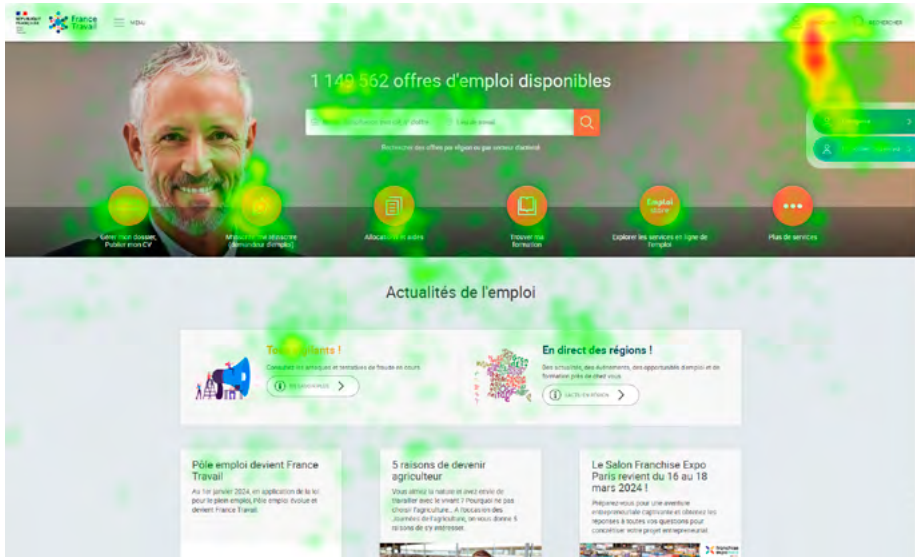
Cette image illustre les résultats agrégés des mouvements oculaires des participants capturés avec un eyetracker. Les couleurs représentent la répartition des regards sur la page : le vert indique peu de regards, tandis que le rouge correspond à des zones d'intérêt où une forte concentration de regards a été observée.
